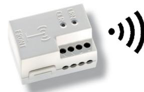
**Monitoring et relais pour appareils de puissance**
