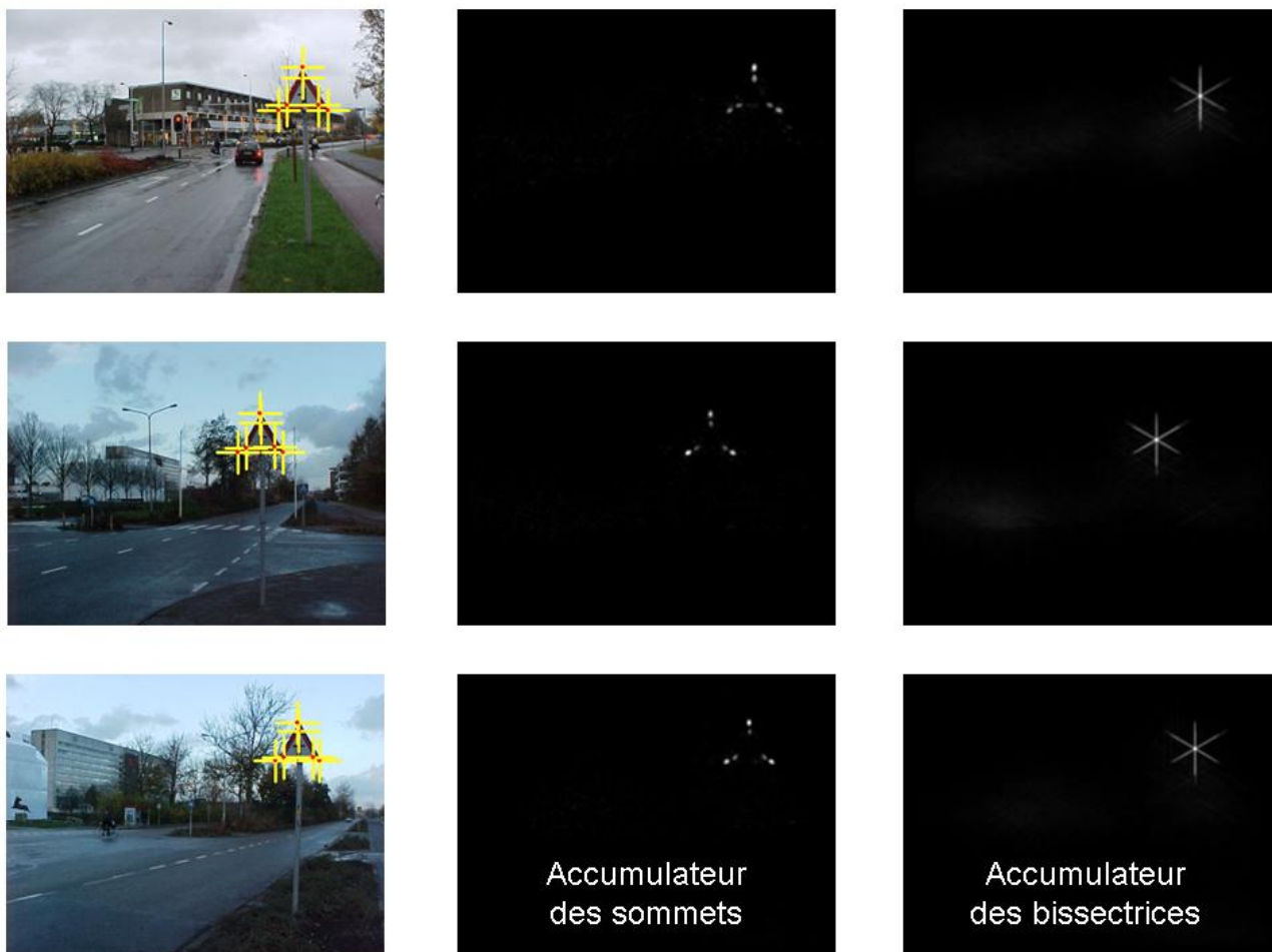
FIG. 7 – Exemples de détection de panneaux triangulaires de la base de test avec leurs deux accumulateurs S_{accu} et B_{accu} .
