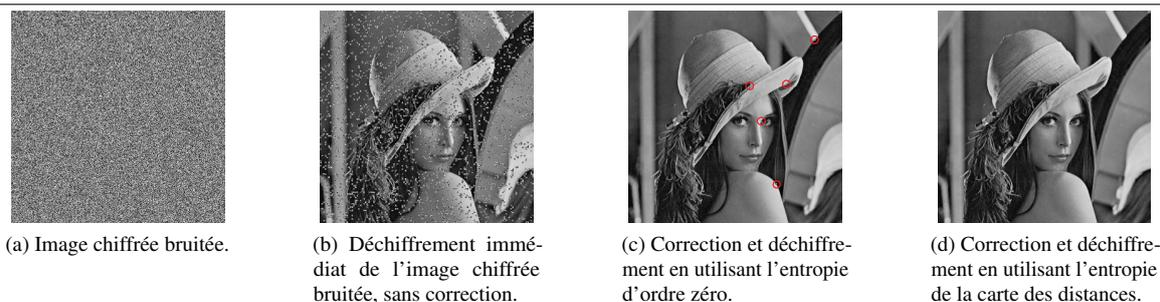
Figure 7 – Exemple d'application de l'utilisation de l'entropie pour corriger une image chiffrée bruitée (image originale présentée fig. 3.a et sa version chiffrée fig. 3.b ,  $BER = 2.6 \times 10^{-3}$ ).
