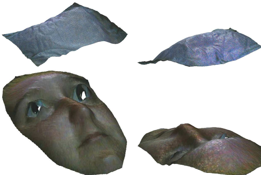
Figure 6: Résultat de la reconstruction 3D à partir du dispositif multimédia, appliquée aux deux séries de 4 images couleur de la figure 4. Le dispositif permet de retrouver à la fois les coordonnées 3D des points de la surface photographiée, et l'albédo relativement à chacun des canaux de couleur. Le dispositif multimédia utilisé est un ordinateur personnel HP EliteBook 8570w avec caméra HD 1280 × 720.
