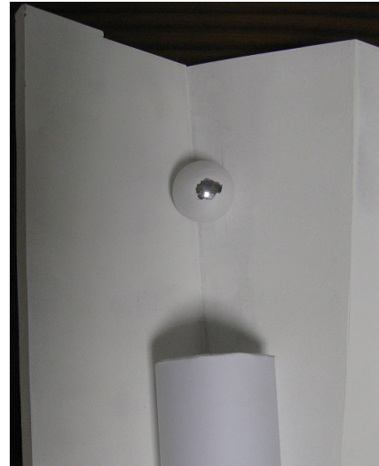
FIGURE 12 – Objet test avec réflexion spéculaire sur la sphère pour tester notre approche.
