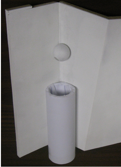
FIGURE 2 – Objet utilisé pour tester notre approche. L'objet est composé de formes géométriques simples (plans, sphère et cylindre) ainsi que de plusieurs zones saillantes (discontinuités).
