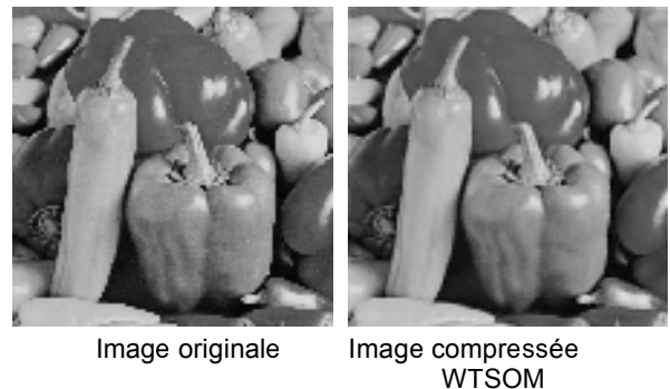
Fig. 3 : Image compressée WTSOM : PSNR=29,37 dB
