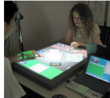
Figure 2: Deux utilisateurs interagissant simultanément avec une table interactive et le logiciel DiamondSpin [6].
