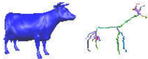
Figure 8 – Le modèle "Cow" à gauche et son squelette à droite. Les branches du squelette apparaissent d'une couleur différente.
