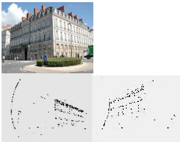
Figure 7- Les cercles K correspondant aux gerbes perspectives de deux façades d'un bâtiment : on notera les nombreux artefacts correspondant aux parties de l'image situées en dessous de l'horizontale.
