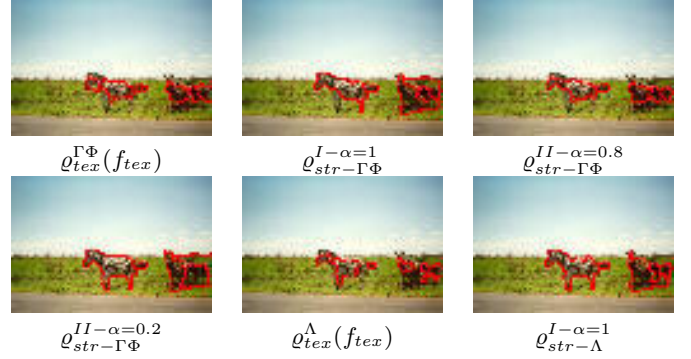
Figure 4 – Exemples de segmentation avec des gradients de texture et de structure (texture+couleur) par LPE et marqueurs, i.e. Wshed(\varrho, mrks) .
