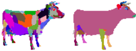
Figure 4 – Segmentation hiérarchique à partir de la ligne de partage des eaux. Modèle Cow avec 208 régions à gauche et 57 régions à droite.
