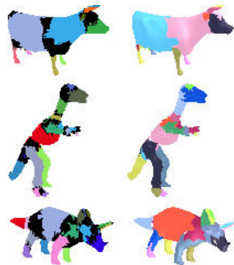
Figure 11 – Marqueurs générés par squelettisation à gauche et résultat de la segmentation par LPE avec marqueurs à droite.
