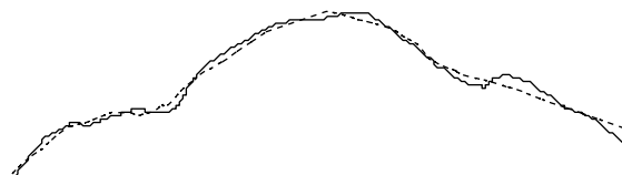
FIG. 4 – Approximation du contour d'une montagne avec 4 points de contrôle et 2 transformations
